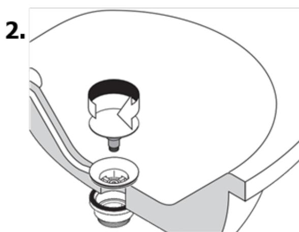
Расположите клапан в отверстии слива, как показано на рисунке, затяните гайку с помощью гаечного ключа, но не перетягивайте ее слишком сильно, чтобы не повредить донный клапан.
