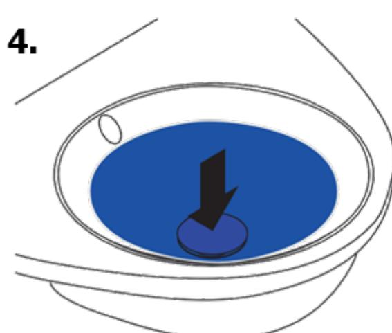
Проверьте, чтобы донный клапан был плотно закреплен. Проверьте соединение на герметичность, открыв воду. Если вы заметили утечку, аккуратно подтяните гайки. После установки убедитесь, что донный клапан работает должным образом, открыв воду и проверив его функциональность. Правильная установка донного клапана позволит вам избежать проблем с протечками и обеспечить надежную работу системы водоотвода
